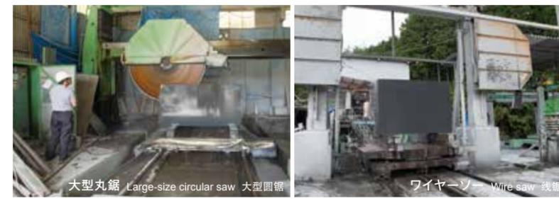
大型丸鋸 Large-size circular saw 大型圓鋸
